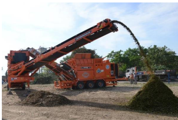
Figura 5 – Sistema de trituração de poda do COMLURB Fonte – RIO, 2018.
