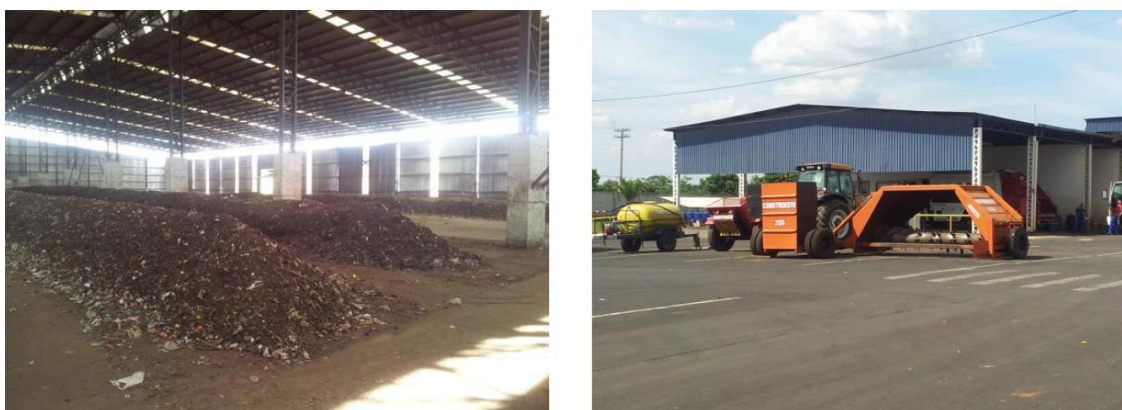
Figura 4 – Leiras em pátios cobertos e máquina revolvedora Fonte – SÃO JOSÉ DO RIO PRETO, 2014
